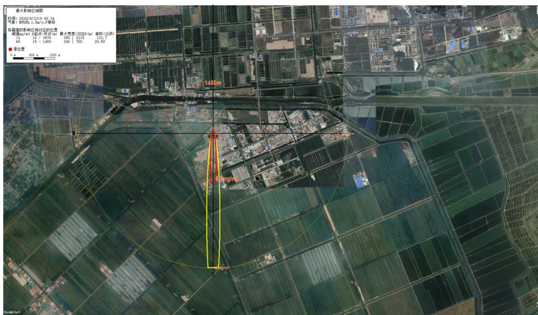
图 6.9.1-7 最不利气象条件氯化亚砷超过阈值的最大轮廓线图
