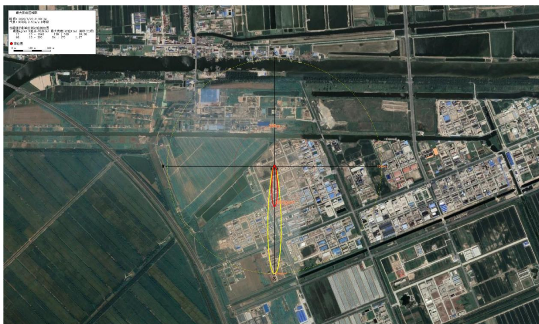
图 6.9.1-7 最不利气象条件氯化亚砷超过阈值的最大轮廓线图
