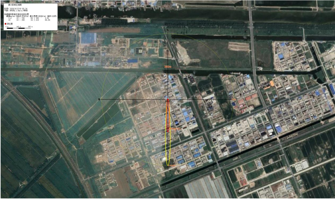
图 6.9.1-5 最不利气象条件双乙烯酮超过阈值的最大轮廓线图
