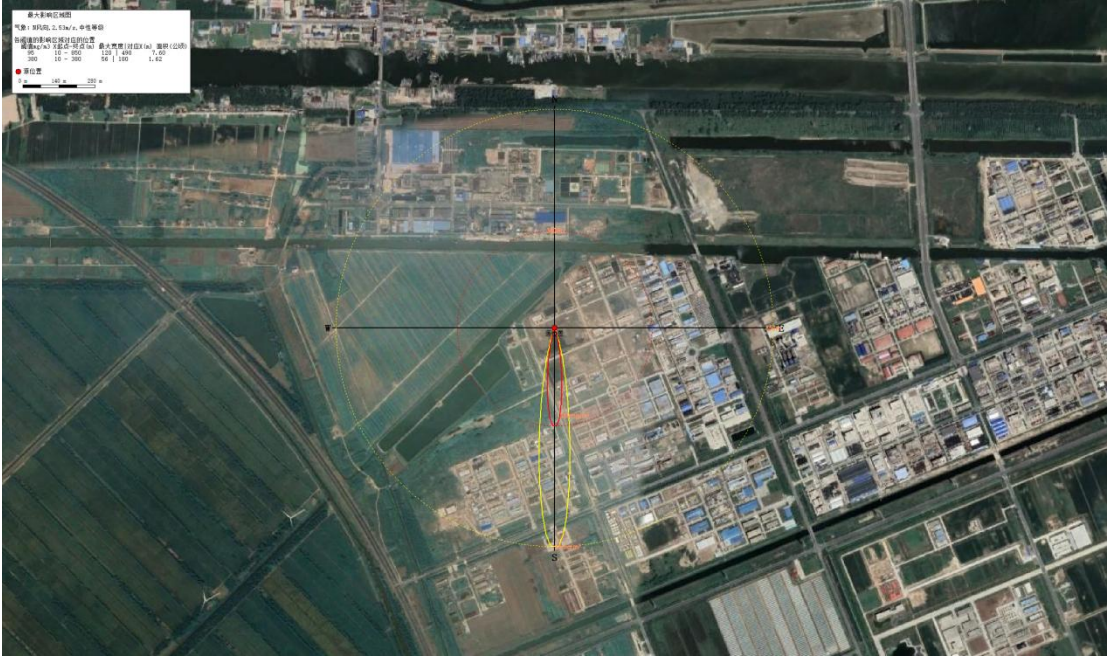
图 6.9.1-2 最常见气象条件 CO 超过阈值的最大轮廓线图
